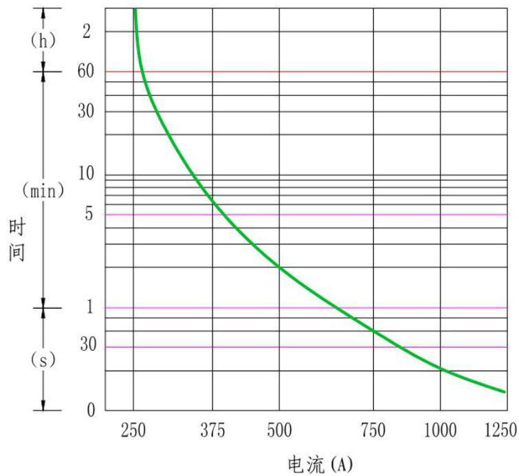
图1 短时过载能力曲线图
