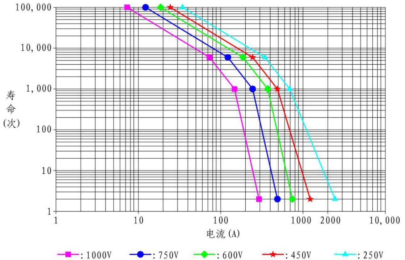
图2 带载切断寿命曲线图
