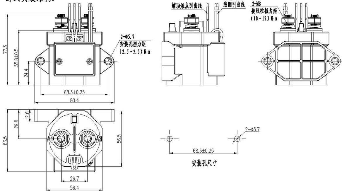
图 1 BSBC7-250 产品外形及安装尺寸图
