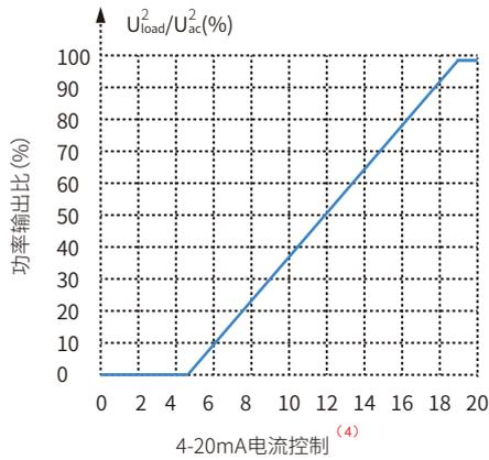
注：<sup>(4)</sup> 输出曲线均在50HZ条件下测得。
