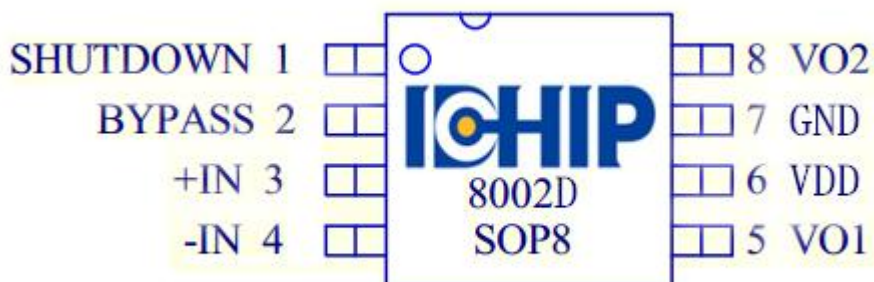
图 2. 8002D SOP-8 封装管脚分布图
