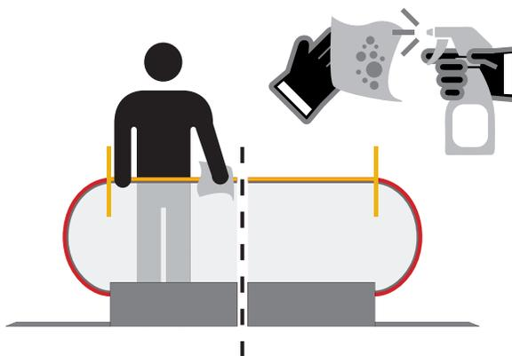
3. Продвиньте эскалатор, чтобы обнажить следующую секцию поручня, повторите процесс до полного завершения.
