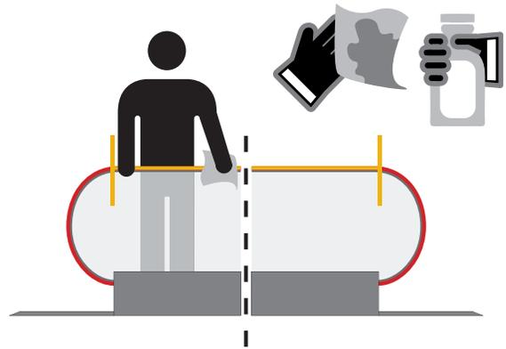
3. Выдвиньте эскалатор, чтобы выставить следующую секцию поручня, повторите процесс до полного завершения.
